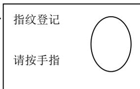
将同一手指放在指纹采集窗口三次，提示成功后自动退回；再按【OK】重复以上操作
